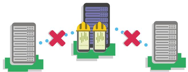
El nodo puede ejecutarse en el campo de operaciones y actuar como un servidor de modo de respaldo independiente. Puede ser configurado como parte del clúster TASSTA y ser conectado de nuevo al sistema con disponibilidad de enlace.
